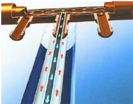
8 – сурет – «Құбырдан құбырға» конструкциясымен жасалған суға тікелей жылу беретін вакуумдық күн коллекторының жұмыс істеу принципі
