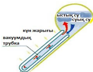
7 – сурет – Тікелей су берілетін вакуумдық күн коллекторының жұмыс істеу принципі
